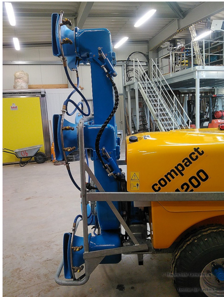
Bild 5: Die Luftauslässe einer Seite lassen sich hydraulisch schließen.
