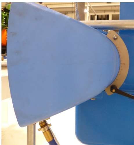
Bild 4: Die Luftdüsen sind schwenkbar und über Knebelschrauben arretiert.
