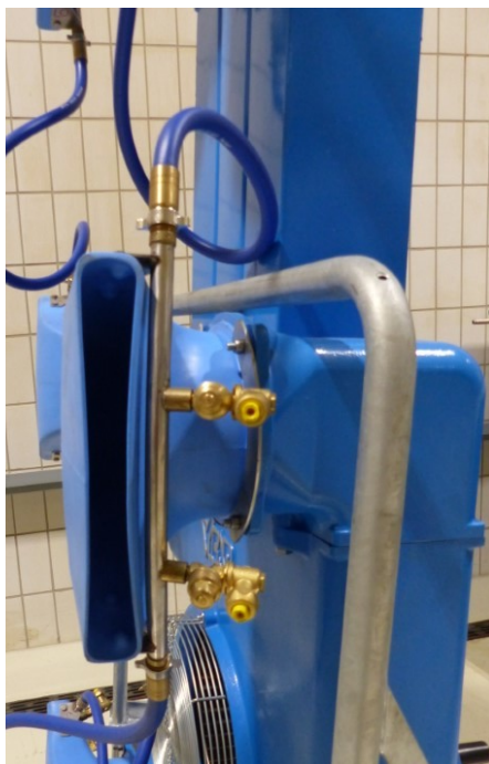
Bild 6: Die Düsenkörper sind paarweise vor den Luftdüsen montiert. Die Flüssigkeitsversorgung erfolgt jeweils pro Seite.
